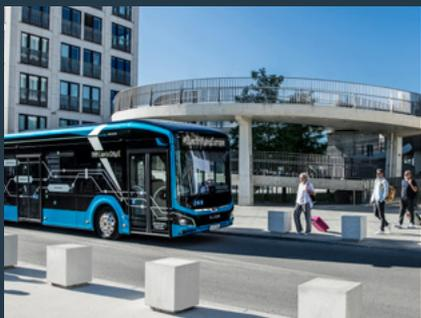
Alors que la topographie et le climat influent sur l'autonomie de tous les véhicules électriques, le facteur de la température extérieure joue un rôle particulièrement important pour l'autobus MAN Lion's City E. Les autobus parcourent souvent jusqu'à 350 km par jour et leurs portes s'ouvrent et se ferment en permanence, le chauffage et la climatisation sont donc particulièrement sollicités. Une analyse plus approfondie de l'autonomie et de la consommation d'énergie est ici requise.
